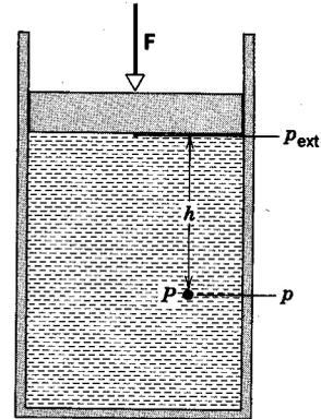
**Figura 7** Un fluido dentro de un cilindro equipado con un émbolo móvil. La presión en cualquier punto  $P$  se debe no solamente al peso del fluido sobre el nivel de  $P$  sino también a la fuerza ejercida por el émbolo.
