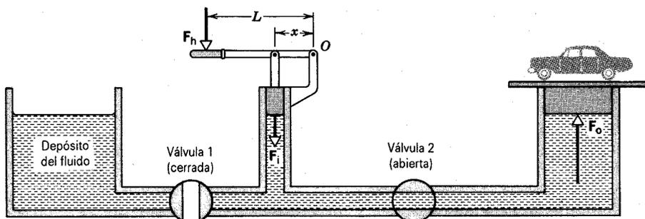
**Figura 9** Problema muestra 2. Se emplea una bomba hidráulica para elevar un automóvil. En la carrera hacia abajo, se cierra la válvula 1 y se abre la válvula 2. Durante la carrera hacia arriba, se abre la válvula 1 y se cierra la válvula 2, permitiendo que se transfiera fluido adicional a la cámara hidráulica.
