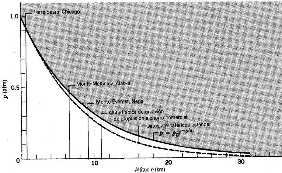
**Figura 5** Comparación entre los datos de la presión atmosférica estándar (línea de puntos) con las predicciones de la ecuación 13 (línea continua). Las dos curvas difieren porque nuestro cálculo despreció la variación de la densidad con la temperatura al aumentar la altitud.
