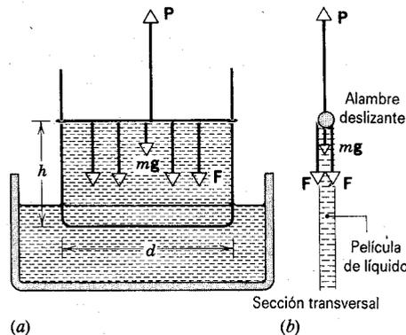
**Figura 15** (a) Diagrama esquemático de un experimento para medir la tensión superficial de un líquido. Una película de líquido se halla sostenida en la parte rectangular vertical, cuyo borde superior es un alambre deslizando. Una fuerza externa equilibra al peso del alambre deslizando más la fuerza total hacia abajo  $F$  de la tensión superficial. (b) Diagrama de la sección transversal de la película, donde se muestra que la tensión superficial actúa sobre dos superficies.
