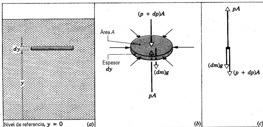
**Figura 2** (a) Un pequeño elemento de volumen del fluido en reposo. (b) Las fuerzas sobre el elemento. (c) Diagrama de cuerpo libre del elemento.
