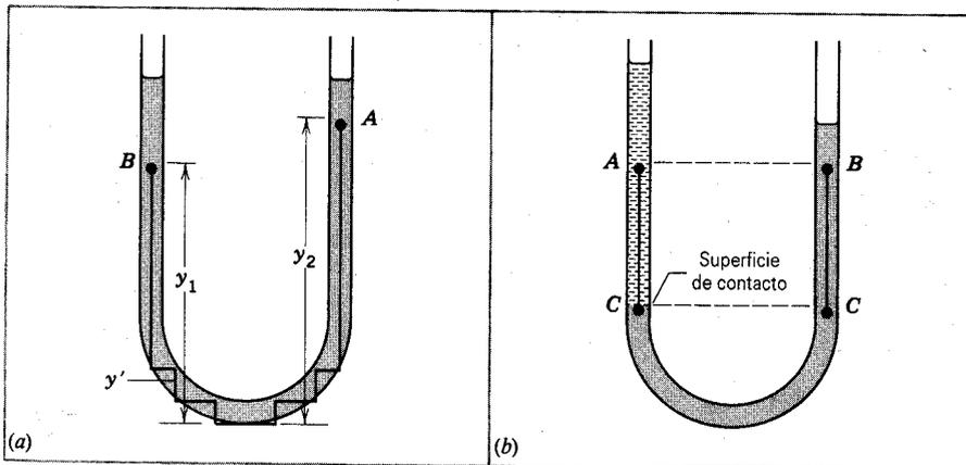
**Figura 4** (a) La diferencia de presión entre dos puntos *A* y *B* de un líquido homogéneo depende únicamente de su diferencia en altura  $y_2 - y_1$ . (b) Dos puntos *A* y *B* a la misma altura pueden estar a diferentes presiones si ahí las densidades difieren.
