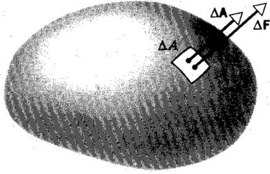
**Figura 1** Un elemento de superficie  $\Delta A$  puede ser representado por un vector  $\Delta \mathbf{A}$  de longitud igual a la magnitud del área del elemento y dirección perpendicular al elemento. El fluido encerrado por la superficie ejerce una fuerza  $\Delta \mathbf{F}$  contra el elemento. La fuerza es perpendicular al elemento y por lo tanto paralela a  $\Delta \mathbf{A}$ .
