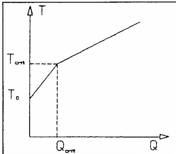
H) La energía transferida para que el pistón se empiece a mover es  $Q_{crit}$ . Ésta debe ser igual al producto de la potencia que disipa el circuito por el tiempo que el mismo deberá estar conectado. Entonces,  $t = (E^2)/(RQC_{crit})$
