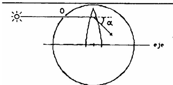
Por el orificio "O" penetra paralelamente al eje óptico, a una distancia  $R/2^{1/2}$  del mismo, un rayo de luz. Después de reflejarse dos veces dentro de la esfera, el rayo sale a través del mismo orificio.
