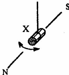
Como siguiente paso se cuelga el imán A de un hilo. Para evitar las pequeñas oscilaciones del imán, se coloca bajo éste la placa de cobre. Como es obvio, el imán A se alinearán a lo largo del campo magnético terrestre  $B_h$ . A continuación se acerca el imán X como se muestra en la figura.
