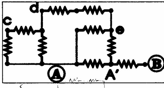
La resistencia total la podemos representar como la suma  $R = r + R_1$ , donde  $r$  es la resistencia del tramo marcado por A A'. El valor de  $R_1$  es:
