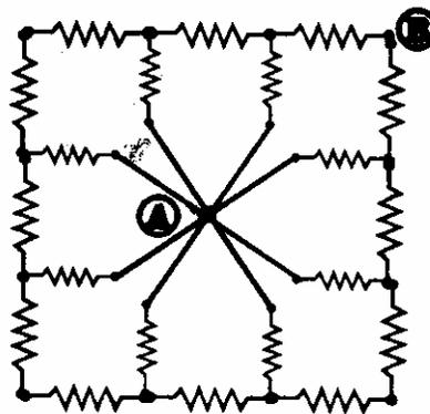
Teniendo en cuenta la simetría del circuito con respecto al eje AB, se pueden unir los puntos con igual potencial eléctrico, de donde se obtiene el siguiente diagrama:
