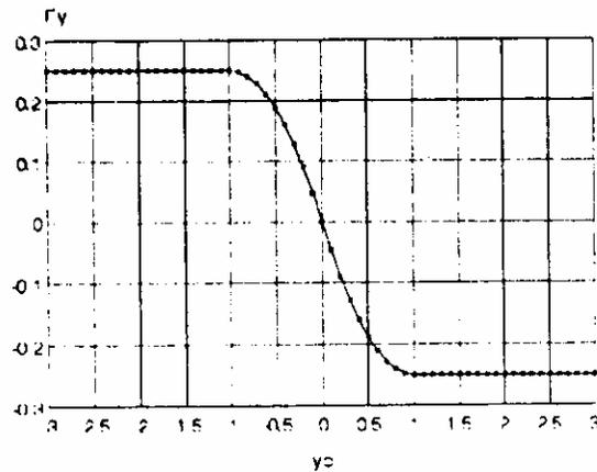
Gráfica normalizada de  $F_y$  en función de  $y_0$  para los casos (a) y (b). La variable  $y_0$  está normalizada a  $h$  y  $F_y$  está a  $[(I_0 w h)/c] \times \text{sen } \theta$ .
