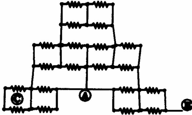
La parte señalada en el diagrama con la letra "c" se elimina. A continuación, reduciendo resistencias en paralelo se obtiene el diagrama (con cada resistencia de valor  $r = \frac{1}{2}\Omega$ ).
